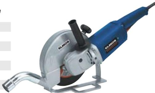
Эта новинка отличается от УШМ скоростью вращения шпинделя — она ниже и более приспособлена для резки камня алмазными дисками. Штроборез оснащен почти замкнутым кожухом с патрубком для пылесоса, так как сухое резание бетона — очень пыльная процедура. Более того, в инструкции содержится
