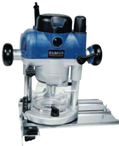
Новинка Elmos оснащена всем, что требуется профессиональному фрезеру. Перечислим самые важные системы: 6-позиционный регулятор скорости вращения, позволяющий устанавливать обороты 8000, 10000, 14000, 18000 или 20000 в минуту; вращающаяся рукоятка настройки глубины фрезерования; рычаг блокировки глубины погружения фрезы; 3-позиционный револьверный ограничи-
